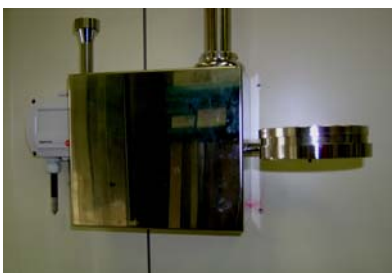
Cleanroom: sonda di monitoraggio in continuo particellare, microbiologico e dei parametri critici
